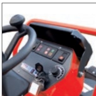
Coperchio antivandalico sistema di controllo Vandal proof cover for the control board
